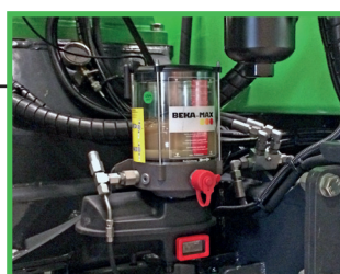
Lubrification centralisée automatique lubrification facile et rapide (en option)
