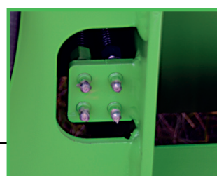
Points de lubrification centralisés lubrification facile et rapide
