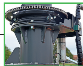
Chute d'éjection rotative commande à distance par moteur électrique
