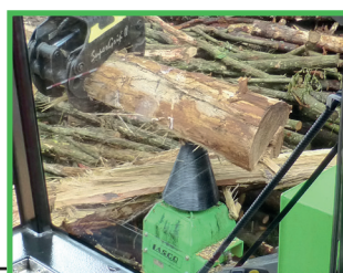
Cône refendeur intégré pour réduire la taille de gros arbres
