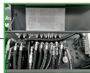
Bloc hydraulique avec manomètre de pression et leviers pour opération manuelle
