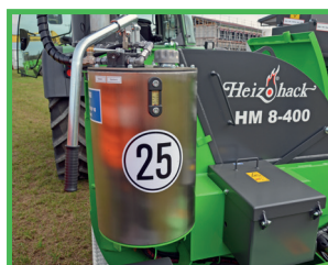
Chute d'éjection réglable en hauteur avec alimentation en huile indépendante
