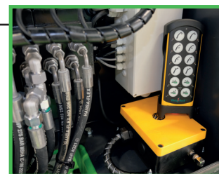
Télécommande radio diverses fonctions hydrauliques
