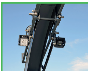
Caméra et phares LED placés au niveau de la chute d'éjection pour une meilleure visibilité
